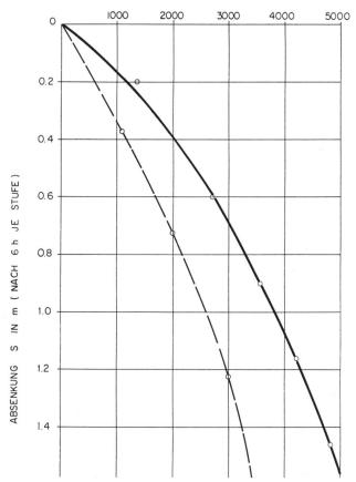
Bild 3. Brunnen Birchhag. \_\_\_\_\_ In den definitiven Brunnen zufliessende Grundwassermenge, —— in den Versuchsbrunnen zufliessende Grundwassermenge.
