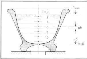
Bild 2. Skizze einer Wasseruhr mit linearer Zeitskala.
