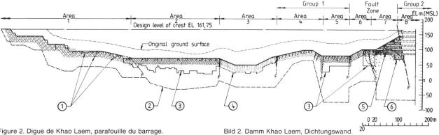
Figure 2. Digue de Khao Laem, parafouille du barrage. 1 tranchée parafouille, 2 limite d'injection, 3 paroi moulée, 4 cellules de chasse, 5 mur parafouille, 6 mini paroi moulée.
