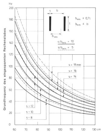
Bild 4. Grundfrequenz eines beidseitig eingespannten Rechteckstabes in Abhängigkeit der Stablänge und Stabdicke. Einfluss des wirksamen
