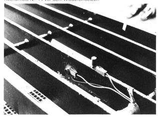
maschine mit einem dämpfenden Belag versehen (früher Stahlrollen), um Schläge der Harke auf den Rechen zu dämpfen.
