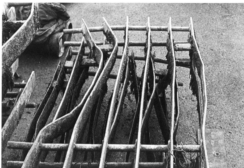
Bild 10, rechts. Einseitige, stark deformierte ausgebaute Rechenfelder der zweiten Generation. Diese ausgebauten Rechenfelder standen in Zonen stärkerer Beanspruchung durch Vibrationen und Geschwemmselbelastung.
