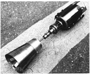
Schleudermaschine für Kunststoffbeschichtung in Rohren mit Glätter.
