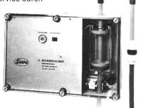
Dieses Gerät eignet sich speziell für die Entnahme von Wasser und Abwasser aus Gewässern, kommunalen Kläranlagen und bei industriellen Betrieben nach der Neutralisation.
