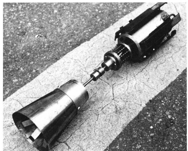
Schleudermaschine für Kunststoffbeschichtung in Rohren mit Glätter.
