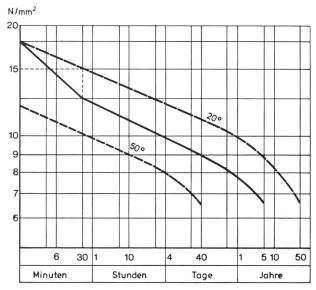
Bild 1. Bleibender Spannungsabfall durch Überdehnung von 30 Minuten Dauer.
