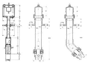
Bild 2, links. Armaturen für die pH-Messung.
