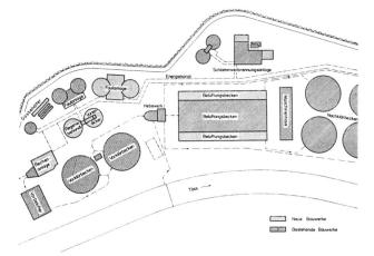
Bild 2. Nördlicher Teil der ARA Hard. Sichtbar ist die überdeckte Rechenanlage mit den umgebauten Absetzbecken der Anlage 39/51. Davor befinden sich die grossen Absetzbecken der Anlage 62/66, die unverändert belassen werden. Rechts schliessen die Belebungsbecken an. Vor dem Waldrand befinden sich links die alten, rechts die neuen Faultürme. Ganz rechts die erweiterte Schlammverbrennung.
