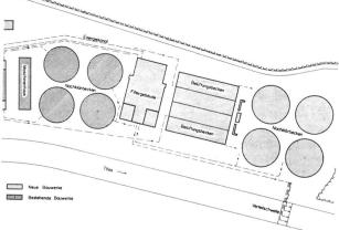
Bild 3. Südlicher Teil der ARA Hard. Links das Gebäude für die Filteranlage. Rechts anschliessend die neuen Belebungs- und Nachklärbecken. Im Vordergrund die neue Auslaufschwelle in die Töss.
