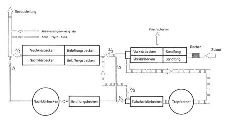
Bei normaler Belastung kann der Tropfkörper mit Zwischenklärbecken ausser Betrieb genommen werden. Die Verteilung des Abwassers auf die biologischen Anlageteile erfolgt in diesem Betriebszustand nach dem Vorklärbecken.
