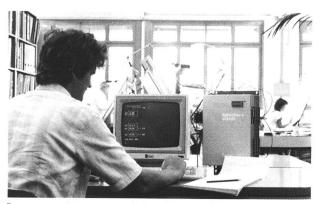
Das neue speicherprogrammierbare Steuergerät Sestep 430 kann mit einem On-line-Bedienungssystem ausgerüstet werden. Der Programmablauf wird am Bildschirm verfolgt; Eingriffe in die laufende Steuerung sind jederzeit möglich.
