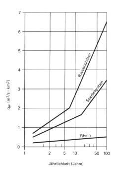
Bild 4, links. Frequenzdiagramm nach *Gumbel* für die Hochwasser- und Abflussspitzen von Sperbelgraben ( $E=0.54~\rm km^2$ ) und Rappengraben ( $E=0.60~\rm km^2$ ) der Messperiode 1903–1958 und als Gegenüberstellung vom Rhein bei St. Margrethen ( $E=6122~\rm km^2$ ) der Messperiode 1931–1960.
