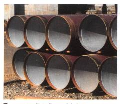
Zementmörtelbeschichtung von Trinkwasserrohren
