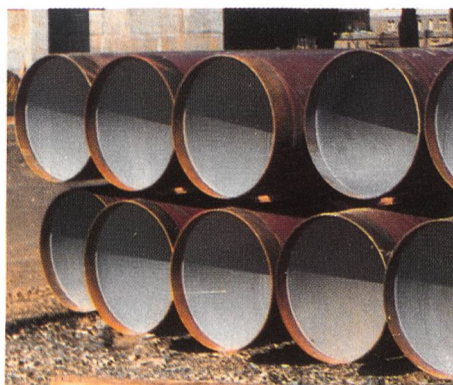
Zementmörtelbeschichtung von Trinkwasserrohren
