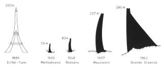
Bild 3. Entwicklung der Bogenmauern in der Schweiz. Von der ersten, aufgrund der Gewölbetheorie erstellten Talsperre der Schweiz in Broc (Montsalvens) mit 55m Höhe bis zum Bau der 237m hohen Mauvoisin-Sperre sind nur knappe 40 Jahre vergangen. Im Nachbartal von Mauvoisin befindet sich die mit 285m höchste Betonsperre der Welt, die Gewichtsmauer Grande Dixence.
