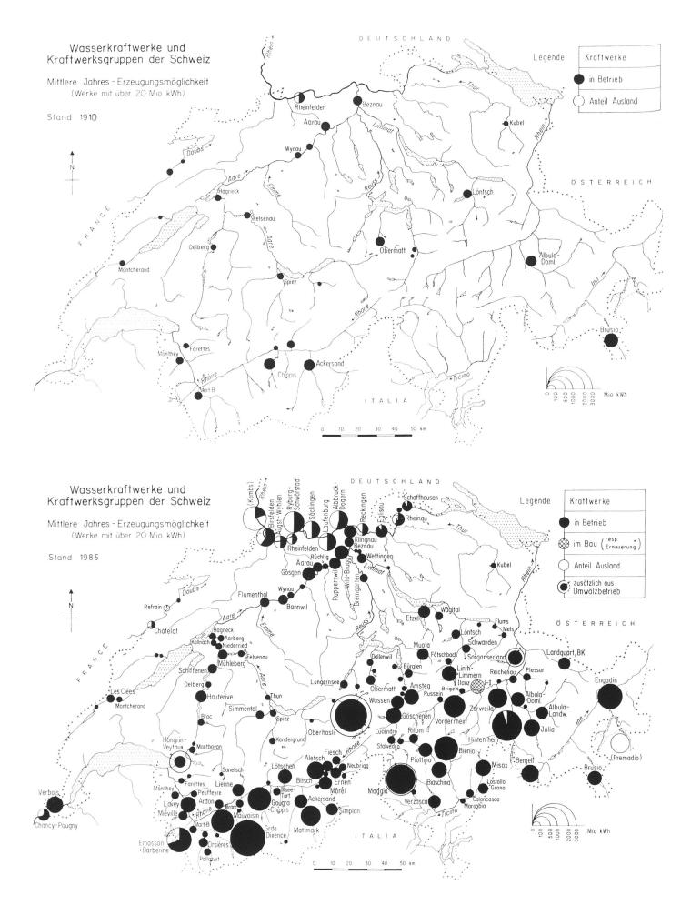
Bild 1. Wasserkraftwerke und Kraftwerksgruppen der Schweiz mit einer mittleren Jahreserzeugungsmöglichkeit von über 20 Mio kWh. Oben: Zustand im Jahre 1910. Unten: Zustand 1985.
