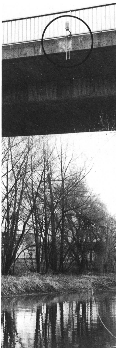
Bild 1, links. Ein hochpräzises Referenzecholot zur berührungslosen Abflusshöhenmessung montiert auf einer Brücke. Bild 2, rechts. Das Referenzecholot.
