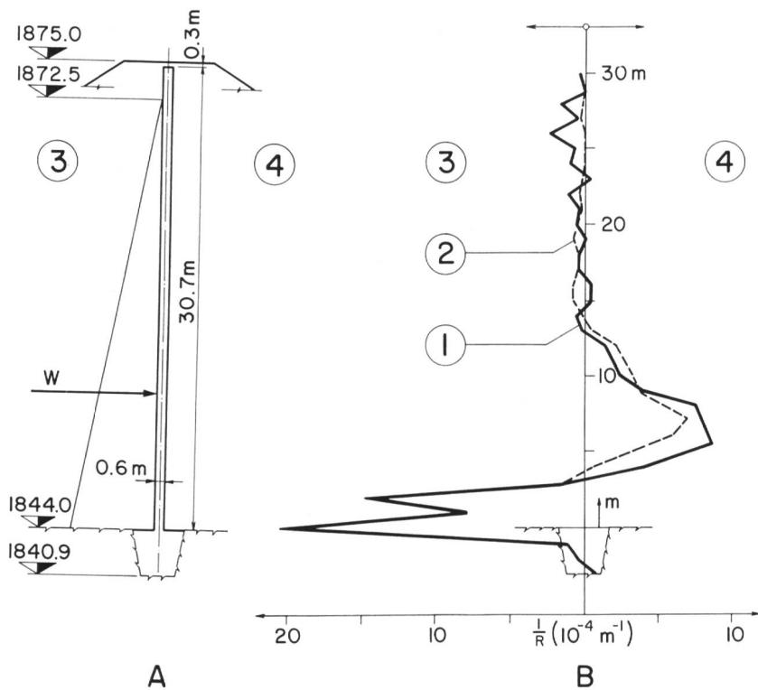
Bild 9. Bockhartsee, Erddamm mit Betonkern-dichtung, Gleitmikrometer, Ergebnisse der Messungen.
