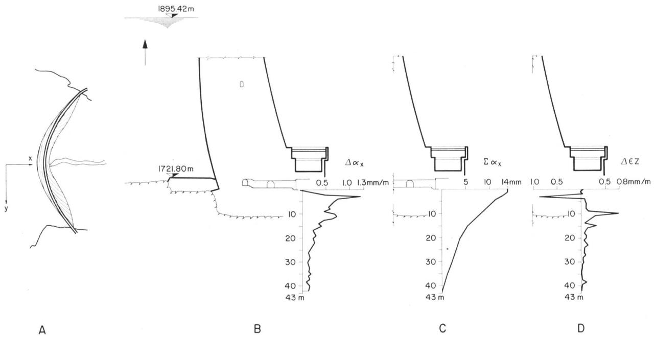
Bild 6. Kölnbrein, Bogenstaumauer, Block 17, Trivec, Ergebnisse der Messungen.
