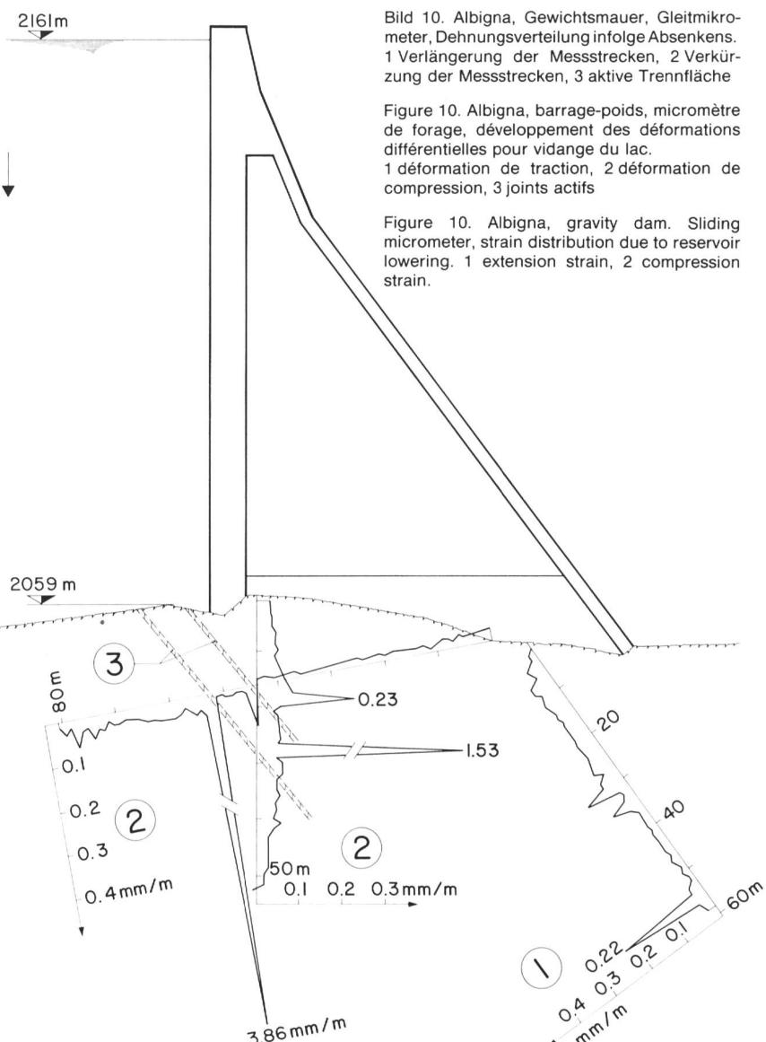
Bild 10. Albigna, Gewichtsmauer, Gleitmikrometer, Dehnungsverteilung infolge Absenkens. 1 Verlängerung der Messstrecken, 2 Verkürzung der Messstrecken, 3 aktive Trennfläche
