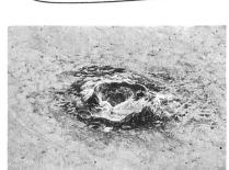
Figure 1, a gauche. Bulles de cavitation à la sortie d'une roue d'un modèle réduit de turbine Francis.
