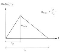
Bild 5. Parameter t<sub>p</sub>, t<sub>d</sub>, die die dreieckförmige Einheitsganglinie bestimmen.
