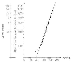
Bild 2. Hochwasserspitzen in Funktion ihrer Jährlichkeit im verzerrten Massstab. Die Abszisse ist logarithmisch verzerrt, die Ordinate nach dem Gaussschen Integral. Dies entspricht der sogenannten Lognormal-Verteilung. Hinterrhein bei Hinterrhein.
