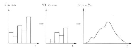
Bild 3. Abflussprozess: Umwandlung der Ganglinie der Niederschlagsintensität N in eine solche der Abflussintensität  $\Phi \cdot N$  und Übertragung in die entsprechende Ganglinie des Hochwasserabflusses Q.
