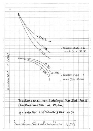
Die Graphik zeigt die Abhängigkeit der Trocknungszeit von Metallogal Purzink ME III von der Oberflächentemperatur und der relativen Luftfeuchtigkeit als Parameter. Es ist augenfällig, dass die höhere relative Luftfeuchtigkeit kürzere Trocknungszeiten hervorruft.
