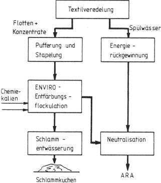
Bild 1. Verfahrenskonzept der Textilwasserentfärbung.
