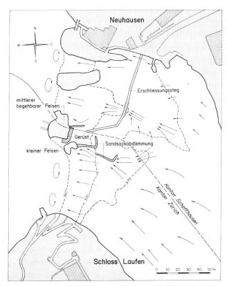
Bild 1. Übersicht über den Rheinfall mit den Installationen für die Erosionsschutzmassnahmen am mittleren, begehbaren Felsen.
