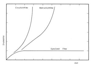
Bild 4. Vergleich des Druckabfalls infolge Filterbeladung bei verschiedenen Filtertypen.
