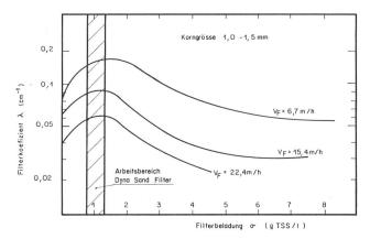
Bild 3. Filterkoeffizient in Abhängigkeit der Filterbeladung für verschiedene Filtergeschwindigkeiten bei einer Korngrösse von 1,0 bis 1,5 mm.
