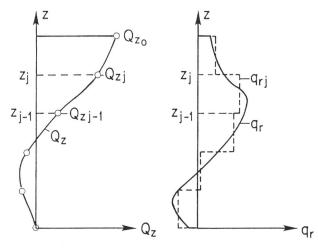
Bild 4. Mit dem Flowmeter ermittelter Volumenstrom  $Q_Z$  in einer Aufschlussbohrung und daraus berechnete radiale Zu- und Wegflüsse  $q_{r_2}$ .
