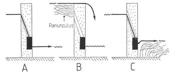
Bild 4. Energieverluste bei Wasserkraftwerken, verursacht durch extremes Wachstum von *Ranunculus fluitans*. A = Normale Bedingungen mit optimaler Wirksamkeit. B = Rechen verstopft mit *Ranunculus* vergrössert die Gefällsverluste am Rechen und verursacht Wasserverluste durch Überlauf. C = Extremes Wachstum von *Ranunculus fluitans* im Unterwasser hebt dort den Wasserspiegel und verkleinert das nutzbare Gefälle (*Thomas* 1983, S. 64).
