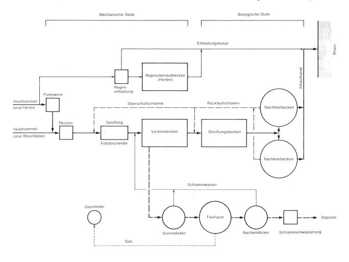
Bild 6. Schema der Abwasserund Schlammbehandlung
