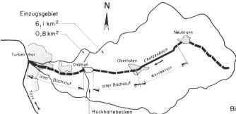
Bild 1. Übersicht der Chatzenbachkorrektion in Turbenthal mit Einzugsgebiet.
