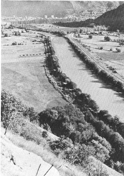
Bild 2. Beispiel eines geraden Flusslaufs ohne alternierende Bänke; Rhone bei Visp (VS).
