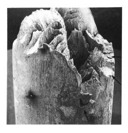
Figure 10, à droite. Surface de rupture sans striction d'un fil de précontrainte (agrandissement 12 fois)
