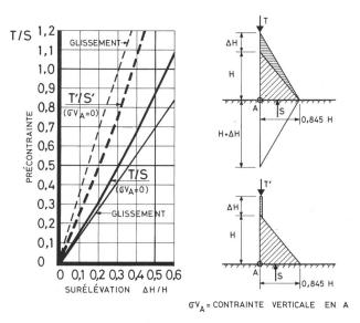
Figure 5. Précontrainte nécessaire à la stabilité d'un barrage-poids surélevé (rapportée à la sous-pression).
