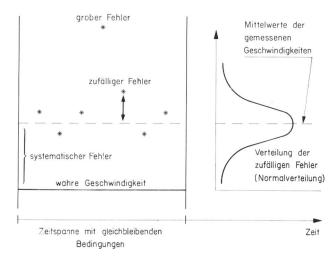
Bild 3. Schematische Darstellung der auftretenden Fehler.
