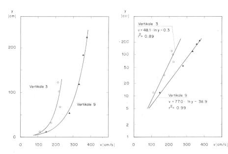
Bild 1. Vertikale Geschwindigkeitsverteilung für zwei Vertikalen in der Reuss bei Seedorf. Messung vom 4.6.1981, siehe auch Bild 2e. Im Bild links linearer Höhenmassstab, im Bild rechts logarithmischer Höhenmassstab. Ausgezogen jeweils die Anpassung nach dem logarithmischen Gesetz.
