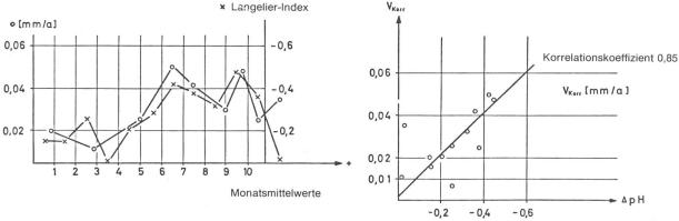
Bild 3. Korrelation zwischen Korrosionsgeschwindigkeit und Langelier-Index.
