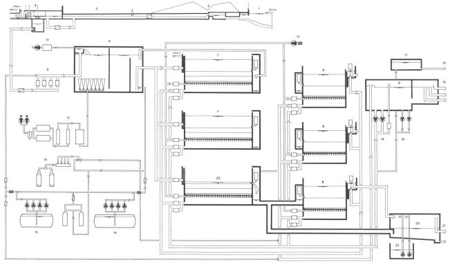
Bild 9. Die «Les Ruinettes»-Wasseraufbereitungsanlage für die Trinkwasserversorgung der Station Verbier. Allgemeines Fliessschema, Städtische Betriebe der Gemeinde Bagnes, Le Châble, Schweiz.
