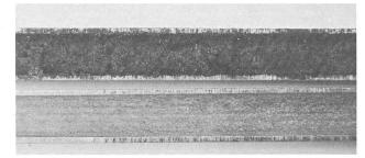
Bild 2. Zwei Wasserleitungsrohre in Bioggio, die beide während zweier Jahre verwendet wurden, das obere für Rohwasser, das untere für aufbereitetes Wasser (bei gleicher Fördergeschwindigkeit).
