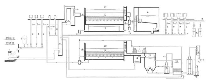
Bild 4. Anordnung der Seewasseraufbereitungsanlage für das städtische Wasserversorgungssystem der Stadt Genf und das Europäische Forschungszentrum CERN.
