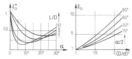
Bild 9.  $\xi_a^*$  für den konisch erweiterten Auslauf (links) und  $\xi_a^*$  für den konisch verengten Auslauf in Abhängigkeit geometrischer Parameter.
