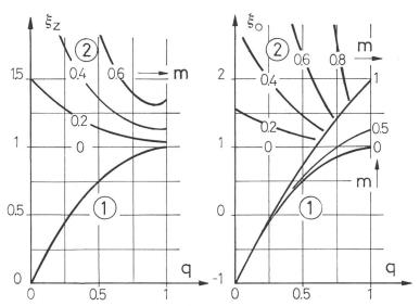
Bild 14. Verlustbeiwerte  $\xi_z$  und  $\xi_o$  für durchgehenden Hauptstrang ( $\alpha_o$ =0) und senkrechte seitliche Einleitung ( $\alpha_z$ =90°) mit m=F<sub>u</sub>/F<sub>z</sub> und ①F<sub>o</sub>=F<sub>u</sub>; ②F<sub>o</sub>+F<sub>z</sub>=F<sub>u</sub>.
