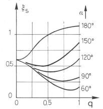
Bild 18.  $\xi$ -Wert in symmetrischen Verzweigungen in Abhängigkeit der Mengenverteilung  $q=Q_a/Q_o$  und des Trennungswinkels  $\alpha$ .
