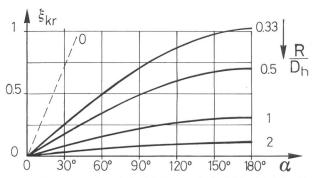
Bild 11. Der Verlustbeiwert in Kreiskrümmern  $\xi_{kr}$  in Abhängigkeit des Umlenkungswinkels  $\alpha$  und des relativen Krümmungsradius R/D<sub>h</sub>mit D<sub>h</sub>=D (kreisprofil) und D<sub>h</sub>=b/3 (nahezu quadratisches Profil).
