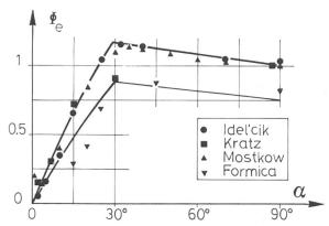
Bild 3.  $\Phi_{\mathbf{e}}$  in Abhängigkeit des Verbreitungswinkels  $\alpha$  nach Versuchen von Idel'cik [12] ( $\blacksquare$ ), Kratz [17] ( $\blacksquare$ ), Mostkow [25] ( $\blacktriangle$ ) und Formica [5] ( $\blacktriangledown$ ) in Druckrohren (obere Kurve) und offenen Gerinnen; Beziehung (6) ist linienhaft festgehalten.
