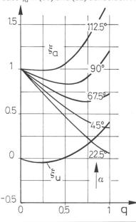
Bild 15. Verlustbeiwerte  $\xi_{\rm u}$  und  $\xi_{\rm a}$  nach Experimenten von Mock [24] in Trennungen bezüglich des durchgehenden «u» und abzweigenden «a» Stranges in Abhängigkeit der Mengenverteilung  ${\bf q} = {\bf Q}_{\bf a} / {\bf Q}_{\bf o}$  und des Abzweigewinkels  ${\bf \alpha}$  für unveränderliche Querschnitte  ${\bf F}_{\bf o} = {\bf F}_{\bf u} = {\bf F}_{\bf a}$ .
