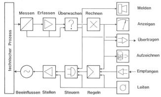
Bild 3. Die Grundstruktur einer Aussenstelle.
