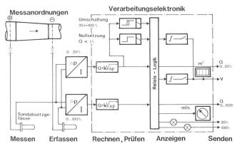
Bild 5. Aussenstelle: Durchflussmessung Göschenen.
