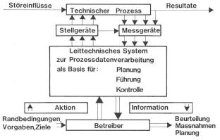
Bild 1. Die Bedeutung der Prozessdatenverarbeitung.
