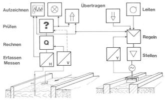
Bild 4. Aussenstelle: Restwassermessung und -regelung.
