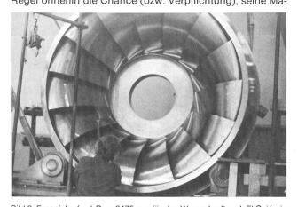
Bild 2. Francislaufrad  $Ds=2475~\mathrm{mm}$  für das Wasserkraftwerk El Cajón in Honduras. Werkaufnahme Ateliers de Vevey
