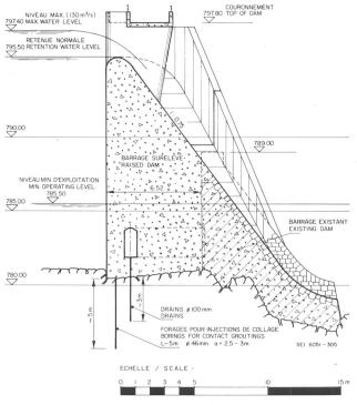
Bild 3. Schnitt durch die Hochwasserentlastung der Staumauer Käppelistutz. Schnitt A–A. Profilzeiger siehe Bild 4.
