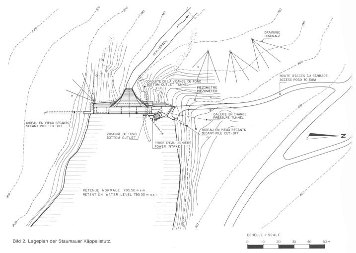
Der Grundablass musste wasserseitig um 7m verlängert werden. Im Querschnitt der Mauerverbereiterung ist der Schützenschacht für die neue Grundablass-Schütze (Tafelschütze mit ölhydraulischem Antrieb) angeordnet. Das Antriebsaggregat ist in einer seitlichen Nische beim Zugang in die Mauer untergebracht.
