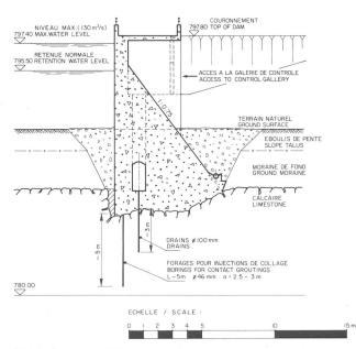
Bild 6. Staumauer Käppelistutz, Querschnitt seitlich der bestehenden Mauer. Schnitt B-B. Profilzeiger siehe Bild 4.
