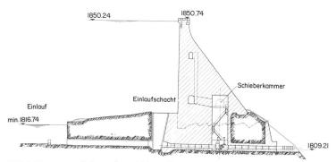
Bild 1. Staumauer Gelmer, Grundablass, Zustand vor der Erneuerung.
