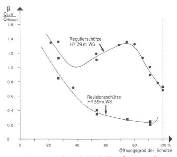
Bild 4. Grundablass Gelmer, Schützenbelüftung, Gemessene Luftmengen Verhältnis  $Q_{Luft}/Q_{Wasser.}$
