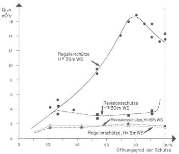
Bild 3. Grundablass Gelmer, Schützenbelüftung, gemessene Luftmengen.
