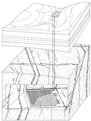
Voici le concept de construction d'un dépôt final pour déchets hautement radioactifs, comme le prévoit la Cédra pour le projet Garantie 1985. Le concept permet une adaptation du système de galeries à la situation géologique. Graphique: un dépôt final dans le socle cristallin de granite du nord de la Suisse, à une profondeur d'environ 1200 mètres.
