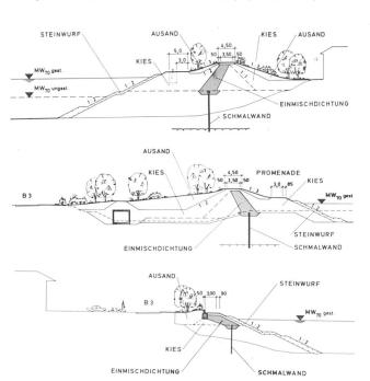
Bild 11. Rückstau- und Hochwasserdämme im Stauraum für die Ortsbereiche Pöchlarn (oben), Kleinpöchlarn (Mitte) und Marbach (unten).
