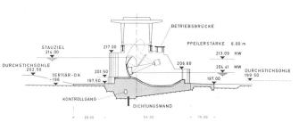
Bild 8. Wehranlage der Staustufe, Querschnitt.
