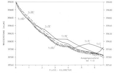
Bild 13. Fortpflanzung und Dämpfung einer Schwallwelle bei Hochwasser ( $Q_{\rm Rhein}=700\,{\rm m}^3/{\rm s}$ ). Mittlere Schwallgeschwindigkeit gegenüber den Ufern: 4,7 m/s.
