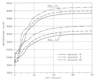
Bild 8. Ansteigen des Wasserspiegels in der Stauhaltung Rheinau bei Ausfall einer Turbine (Fall T1) bzw. beider Turbinen (Fall T2). Die Rechnung beruht auf einer Wasserführung von  $Q_{\rm Rhein}=405\,{\rm m}^3/{\rm s}$ .
