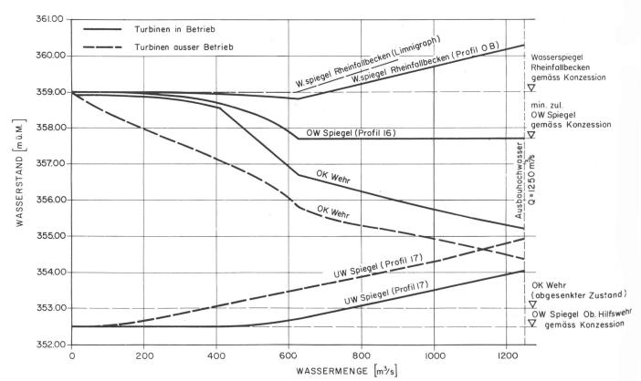
Bild 5. Regulierreglement für das Stauwehr beim Kraftwerk Rheinau (die Profilangaben beziehen sich auf Bild 2).
