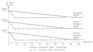
Bild 9. Zeitlicher Verlauf der Wehrabsenkungen.
