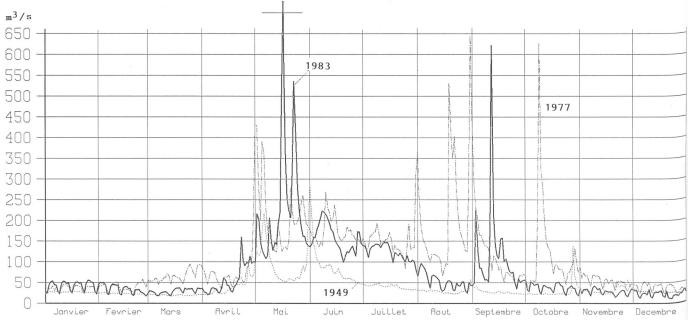
Portate del Ticino a Bellinzona, curva delle portate e curva di durata delle portate. Imbrifero superficie 1515 km², estensione glaciale 1,1 %. Portata annua media 1921–1983 69,4 m³/s, anno 1983 77,2 m³/s.
