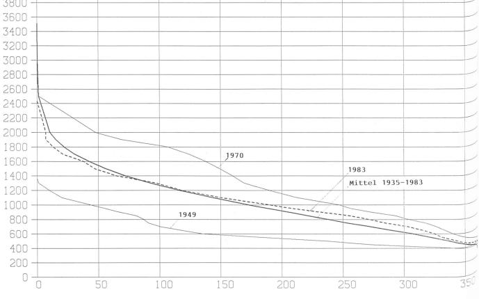
Abflussmengen des Rheins bei Rheinfelden. Oben Ganglinien, unten Dauerkurven. Einzugsgebiet 34550 km², Vergletscherung 1,6 %. Jahresabflussmenge 1935–1983 1037 m³/s, Jahr 1983 1061 m³/s.
