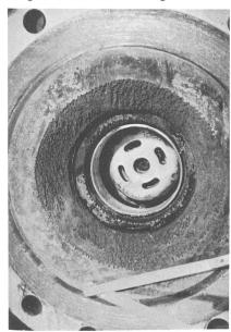
Bild 5. Kavitiertes Ringkolbenventil.
