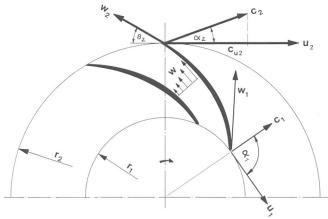
Bild 11. Geschwindigkeitsvektoren am Pumpenlaufrad
