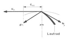
Bild 12. Geschwindigkeitsvektoren an einem Pumpenlaufrad für (oben) Pumpen- und (unten) Turbinenbetrieb.
