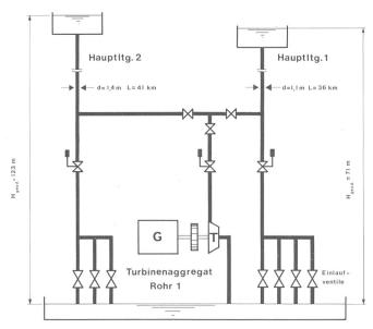
Bild 7. Einlaufsystem Hochbehälter Rohr. / = 100 000 m³.
