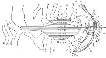
图 1 江厦湖汐电站枢纽总布置图 **A**一大坝, B—水闸, C—库侧渠 道, D—厂房, E—装卸场, F—开关站, G—海侧渠道。
