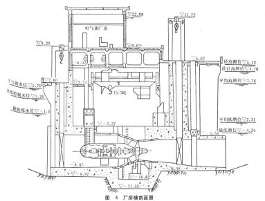
Kraftstation Jiangxia mit Schleusen, Turbinen- und Generatorenraum; rechts oben: Zyklus des Wasserdurchlaufs und Generatorenbetriebs.
