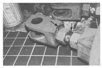
Bild 7. Starke Vibrationen machten das Verschweissen der Stellschrauben an den Leitschaufellenkern dieser Pumpturbine erforderlich (siehe Pfeile).
