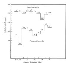
Bild 2, links. Durchschnittliche Verfügbarkeit in den Jahren 1971 bis 1980. Die Zahlen über den Kurvenzügen geben die jeweils erfasste Anzahl Maschinengruppen an.
