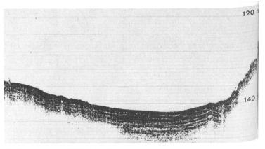
Bild 2. Echogramm (33 kHz) des Seegrundes zwischen Quinten (links) und Walenstadt (rechts). Es zeigt die deutlich ausgeprägte Feinschichtung der Sedimente in der zentralen See-Ebene.
