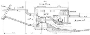
Bild 4. Längsschnitt des Zentralengebäudes mit Rechenanlage
