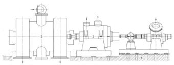
Bild 1. Mit der Modalanalyse untersuchte Maschinengruppe. 1 Fundament, 2 Dampfturbine, 3 Kesselspeisepumpe, 4 Zubringerpunpe.
