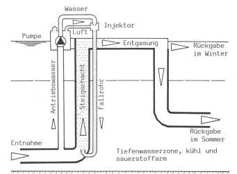
Bild 3. Die Funktionsweise des Seelüftungsgerätes im Hüttnersee.
