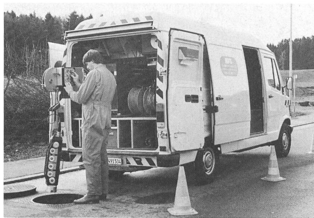
Bild 1. KFS-Kanalfernseh-Fahrzeug mit Kamerawageninstallationen.
