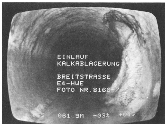
Bild 4. Monitorbild beschriftet mit Messdatenzeile unten: Distanz, Gefälle, Querneigung des Kamerawagens.
