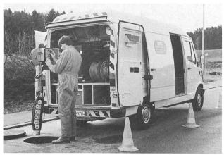
Bild 1. KFS-Kanalfernseh-Fahrzeug mit Kamerawageninstallationen.
