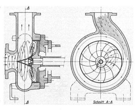
raturgrenze wird durch die Ausführung der Dichtelemente gegeben. So wird ein Höchstwert für ungekühlte Stopfbüchsen von 105°C angegeben, für gekühlte Stopfbüchsen ein solcher von 160°C, und bei Gleitringdichtungen liegt dieser Wert bei 120 ° C. Dem steht eine Minimaltemperatur von −10 ° C gegenüber. Der maximale Betriebsdruck wird mit 10 bar angegeben.
