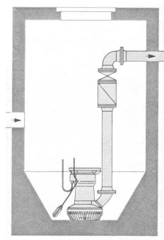
Bild 5. Tauchmotorpumpen. Einsatzbeispiel mit Flanschrohr und Krümmer (KSB, Zürich).
