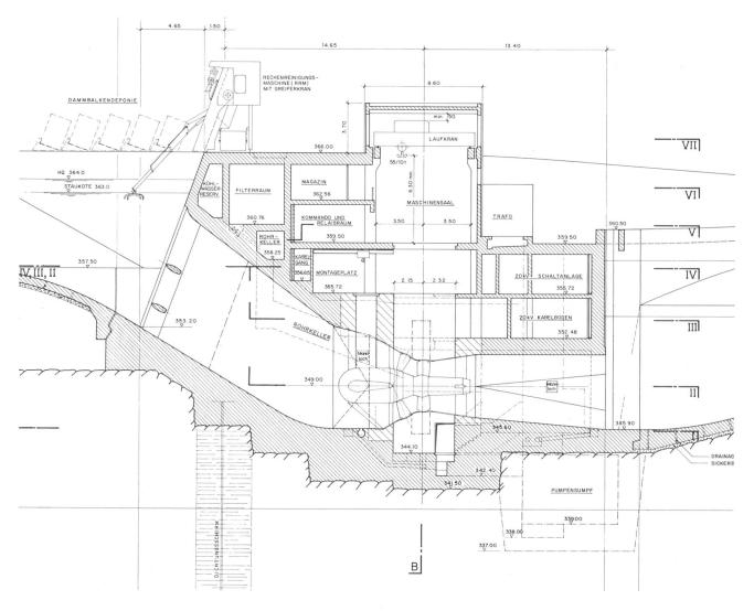
$\operatorname{\mathsf{Bild}}$  2. Längsschnitt durch das Maschinenhaus der Anlage Weinzödl an der Mur.
