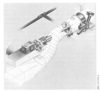
Bild 3. Beispiel einer horizontalen Anordnung für kleine Wasserkraftwerke: von rechts nach links: die Propellerrohrturbine, das Getriebe zur Drehzahlerhöhung, der Generator in der listenmässigen Bauform IM B3.
