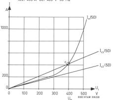
Bild 6. Leerlaufcharakteristiken Asynchrongenerator, pQO 500 ab 6, 400V, 50 Hz, 900 kW, 1008  $\rm min^{-1}$ . Anlage WKW Moutier.
