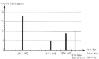
Bild 16. Anzahl der Asynchrongeneratoren in Funktion des Inbetriebsetzungsjahres in der Schweiz im Zeitabschnitt 1961 bis 1980.
