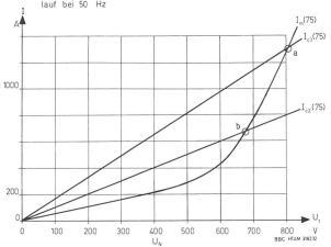
Bild 7. Leerlaufcharakteristik Asynchrongenerator, pQO 500 ab 6 bei  $75\,\mathrm{Hz}.$
