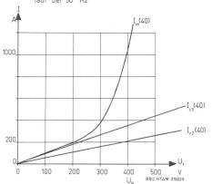
Bild 8. Leerlaufcharakteristik Asynchrongenerator, pQO 500 ab 6 bei 40Hz.
