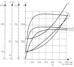
Bild 18. Charakteristiken Asynchrongenerator, pQO 500 ab 6, 400 V, 50 Hz, 900 kW, 1008  $\rm min^{-1},$  Anlage Wasserkraftwerk Moutier.
