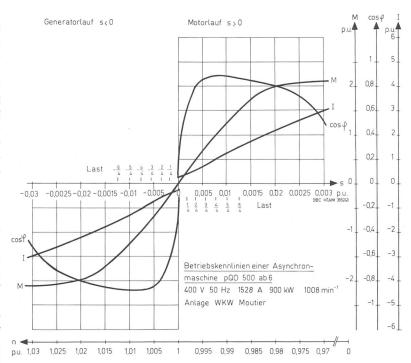
Bild 2 zeigt die Kennlinien zwischen der synchronen Drehzahl (s=0, n=1 pu  $=1000~\text{min}^{-1}$ ) und dem Kippschlupf ( $s_{\mathbf{k}}=\pm0,031~\text{pu}$ ). Der dauernd ausnutzbare Bereich liegt zwischen Leerlauf und Nennlast ( $\frac{4}{4}$ Last).  $\frac{5}{4}$ - und  $\frac{6}{4}$ -Last können nur kurzzeitig genützt werden.
