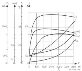
Bild 20. Charakteristiken Asynchrongenerator, MQG 3414 ko, 6600 V, 50Hz, 3200 kW, 431  $\rm min^{-1}$ , Anlage Wasserkraftwerk Lessoc der Entrepriser ses Electriques Fribourgeoises.
