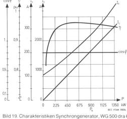
Bild 19. Charakteristiken Synchrongenerator, WG 500 dra 6, 400 V, 50 Hz, 900 kW, cosφ 0.8, 1000 min<sup>-1</sup>
