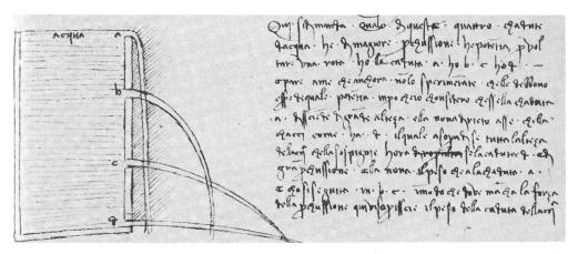
Ausfluss aus einem Gefäss nach Leonardo da Vinci. Auf Bodenhöhe haben die vier Strahlen a, b, c, d dieselbe Energie.
