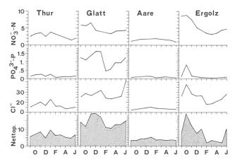
Bild 4. Jahresverlauf von Nitrat, Phosphat, Chlorid und Nettoproduktion im Wasser von Thur, Glatt, Aare und Ergolz, NO $_3^-$  – N, PO $_4^3$  – P, CI $^-$  in mg · I $^-$ 1; Nettoproduktion (Nettop.) in ml 0,1 N KMnO $_4$ ; O, D, F, A, J siehe Bild 3.
