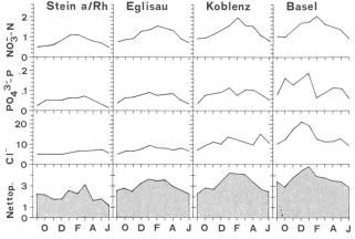
Bild 3. Jahresverlauf von Nitrat, Phosphat, Chlorid und Nettoproduktion im Rheinwasser der Stellen Stein am Rhein, Eglisau, Koblenz und Basel. NO $_3$  – N, PO $_4$   $^3$  – P, Cl $^-$  in mg.l $^{-1}$ ; Nettoproduktion (Nettop.) in ml 0,1 N KMnO; O Oktober; D Dezember; F Februar; A April; J Juni.
